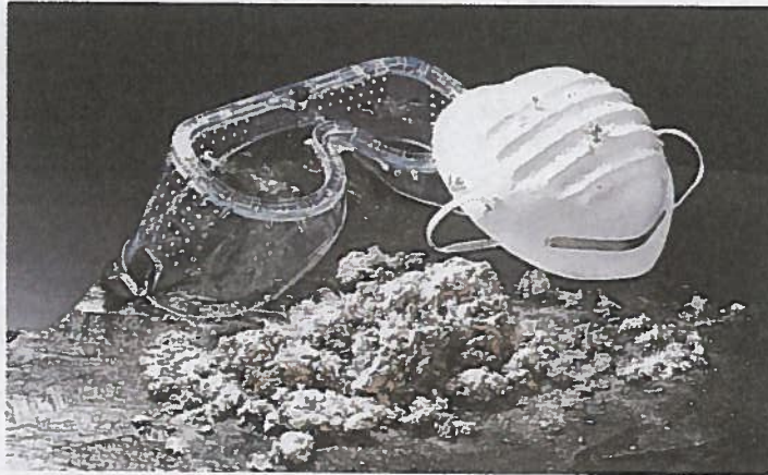
Tückisch an Asbest sind die feinen Fasern, die noch nach Jahrzehnten Krebs auslösen können. Foto: Fotolia/hikoshot.com
